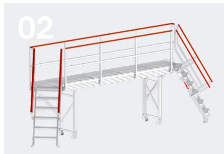
Ejemplo con anchura de 600 mm; longitud de 3 900 mm; revestimiento de la escalera y la plataforma de rejilla de aluminio R13; escaleras colocadas en ángulo de 45° con respecto a la plataforma
