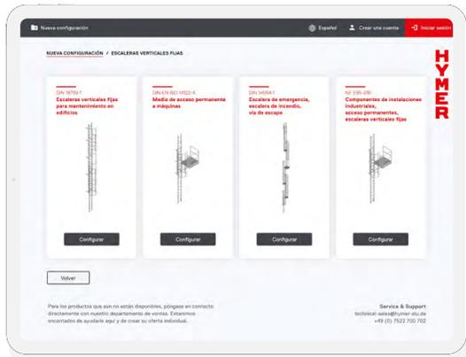
Tenemos disponibles cuatro tipos de escaleras verticales fijas conformes a las normas: para instalaciones de construcción, instalaciones de maquinaria e industriales y salidas de emergencia.
