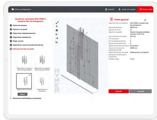
Configuración fácil de usar en unos pocos pasos: introducir la altura de subida (se muestra automáticamente la protección dorsal), definir la plataforma, determinar la variante de subida y bajada y, a continuación, seleccionar los elementos individuales/accesorios.
