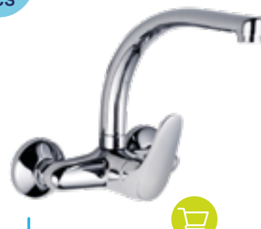
PARED FIGUS 144317 Cuerpo de latón, Maneta Metálica, Cartucho Ø 40 mm, aireador M24, caño giratorio, certificación Sanitaria ACS. Alto 16,5 cm (Distancia entre el eje de la maneta y la base del atomizador). 39'95
