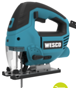
SIERRA DE CALAR 18V 144651 Agarre de goma sobre molde. Velocidad variable. Interruptor de bloqueo, luz LED. Interruptor del soplador de polvo. Con conexión para extracción de polvo externa. Placa base de aluminio, cortes a inglete 45° ajustables a izquierda y derecha. Ajuste de velocidad eléctrico. Potencia nominal: 850 W Velocidad sin carga: 0-3000/ min. Longitud de carrera: 20 mm Capacidad de bisel: 45 grados a la izquierda y a la derecha Función de péndulo: 4 Profundidad máxima de corte en acero: 12 mm Profundidad máxima de corte en plástico: 15 mm Profundidad máxima de corte en madera. 49'95
